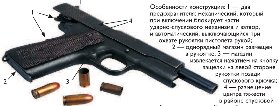
Основные детали (неполная разборка) пистолета M1911.
