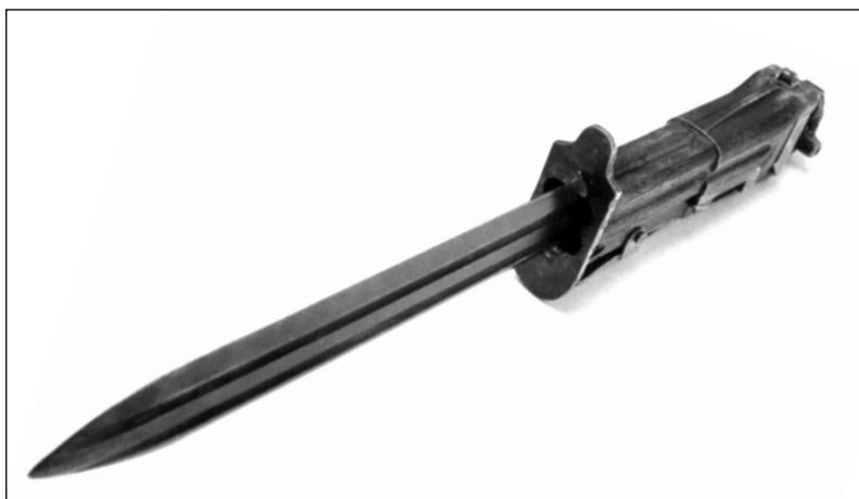
Вариант стреляющего ножа — опытный российский нож «Хамелеон» с четырехствольным стреляющим приспособлением.
