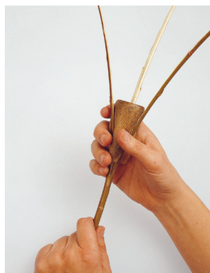
Расщепление прута на три ленты
