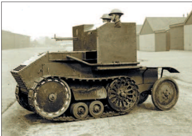
Танкетка «Моррис-Мартель» двухместного типа, мод. 1927 г.
