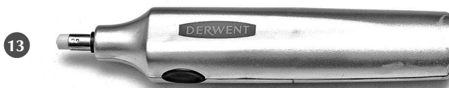
13. Электрический ластик: при нажатии черной кнопки резиновый стержень начинает вращаться.
