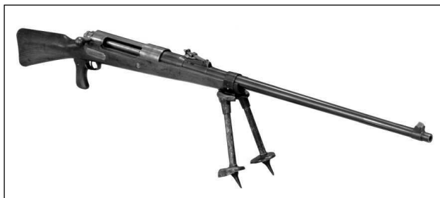
Противотанковое ружье «Маузер» (Tankgewehr 1918) калибра 13,3 мм фактически стало первым серийным специализированным противотанковым средством. Германия, 1918 г.
