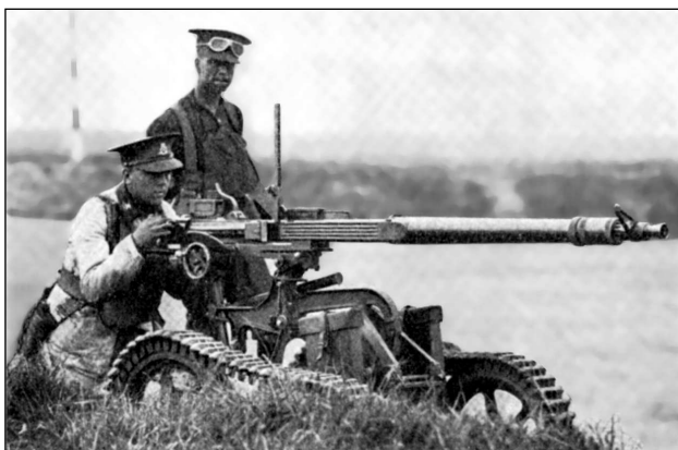
20-мм «противотанковый пулемет» (автоматическая пушка) «Эрликон» на буксируемом гусеничном лафете. Великобритания, 1920-е годы.
