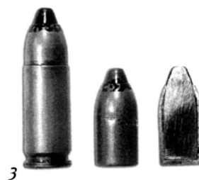
Броневые пули пистолетных патронов: 1—9×18 (7Н25), 2—9×19 (7Н31), 3—9×21 (7Н29). У всех пуль броневой сердечник выступает из оболочки.
