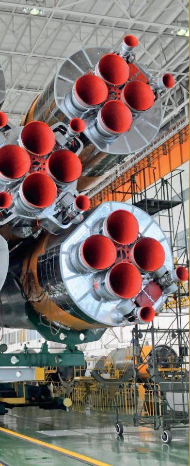
Двигатели ракеты-носителя. Она уже соединена с кораблем «Союз». Фото vicspacewalker
