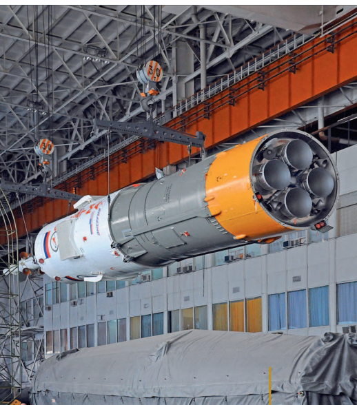
Перемещение ракеты-носителя для корабля «Союз» на космодроме «Байконур» перед запуском. Фото vicspacewalker
