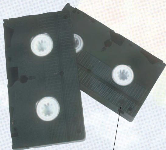
Видеокассета состоит из магнитной ленты, расположенной в пластиковом корпусе, является носителем изображения и звука.
