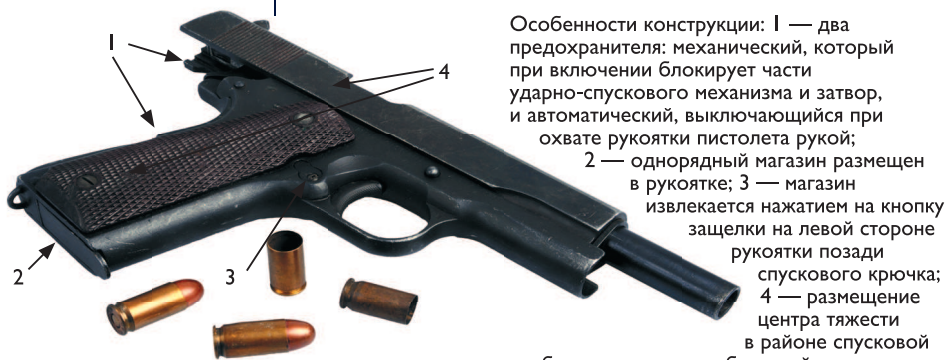
Основные детали (неполная разборка) пистолета M1911.
