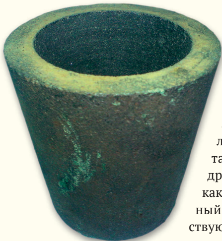
Тигель из графита для плавки металла
