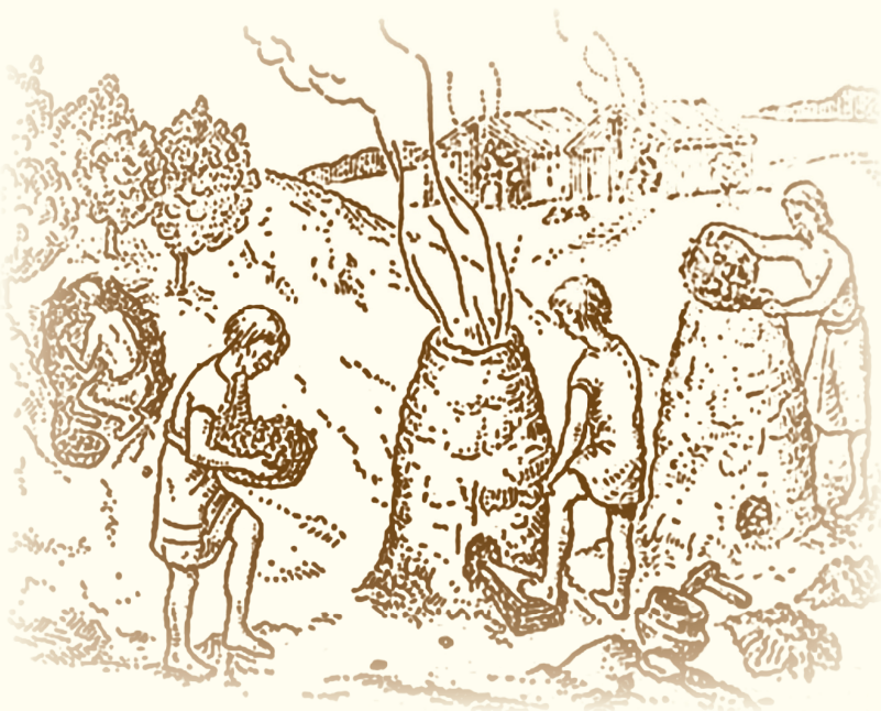
Сыродутная печь представляла собой полое сооружение из камней, обмазанных глиной, или целиком из глины. В стенах были предусмотрены отверстия для раздувания мехами
