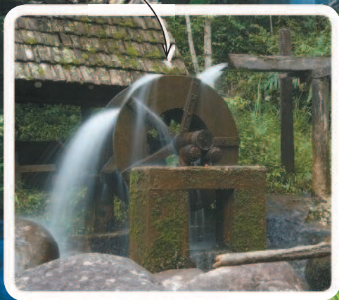
Водяное колесо с верхней подачей воды
