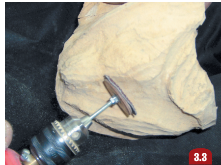
Грубая шлифовка поверхности шара и протяжки
