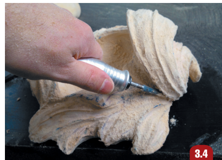
Коническая рашпильная карбид- вольфрамовая шарошка в работе
