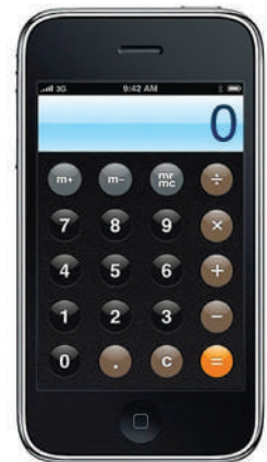
Калькулятор в первых версиях iOS имитировал старый калькулятор Braun ET66 в рамках скевоморфизма
