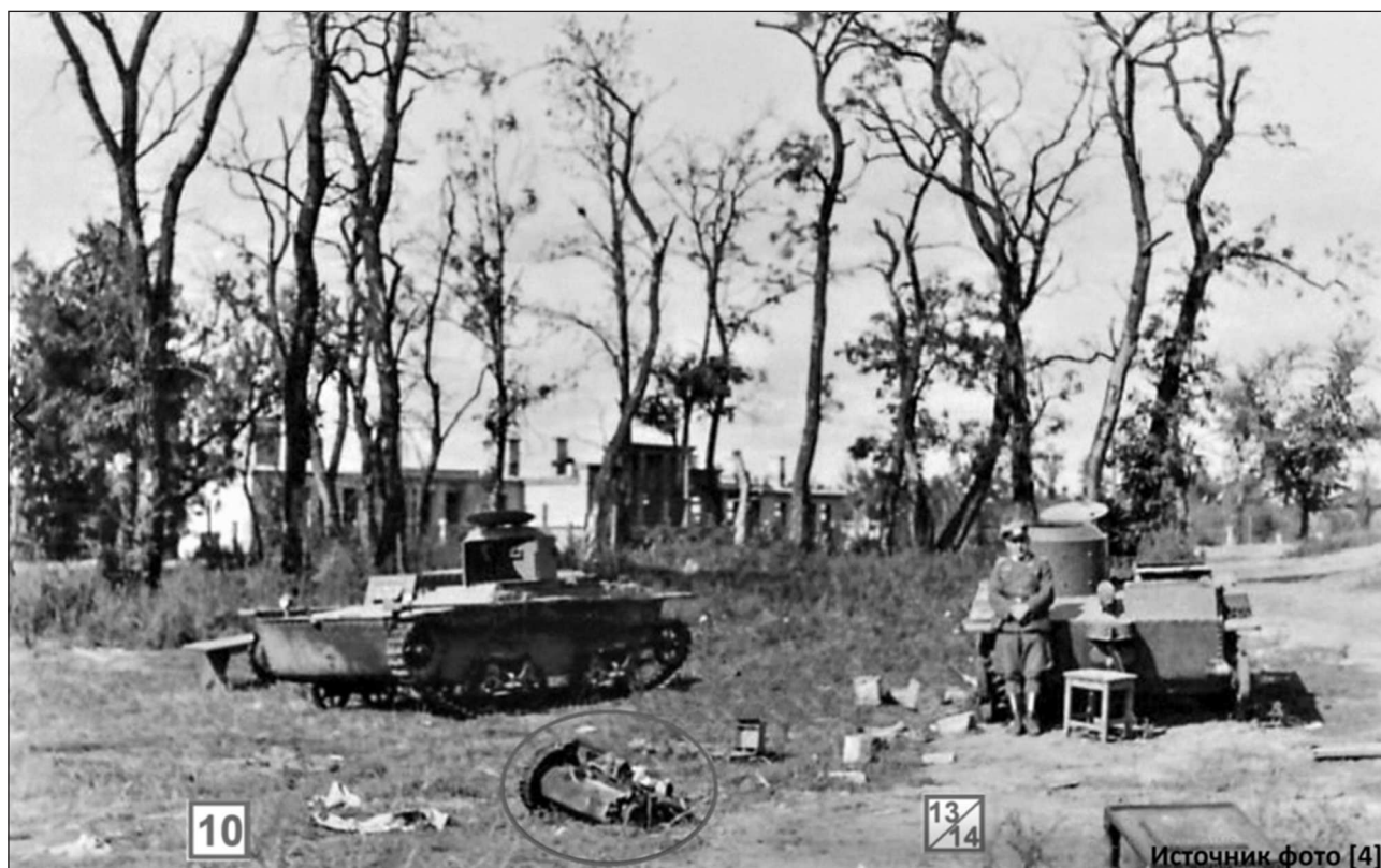
Более позднее фото Т-38 № 10 и № 13 или № 14. Машины явно перетащили на ровное место для транспортировки из крепости и частично разобрали — из Т-38 № 10 вынута часть трансмиссии, очевидно, для починки другой машины
