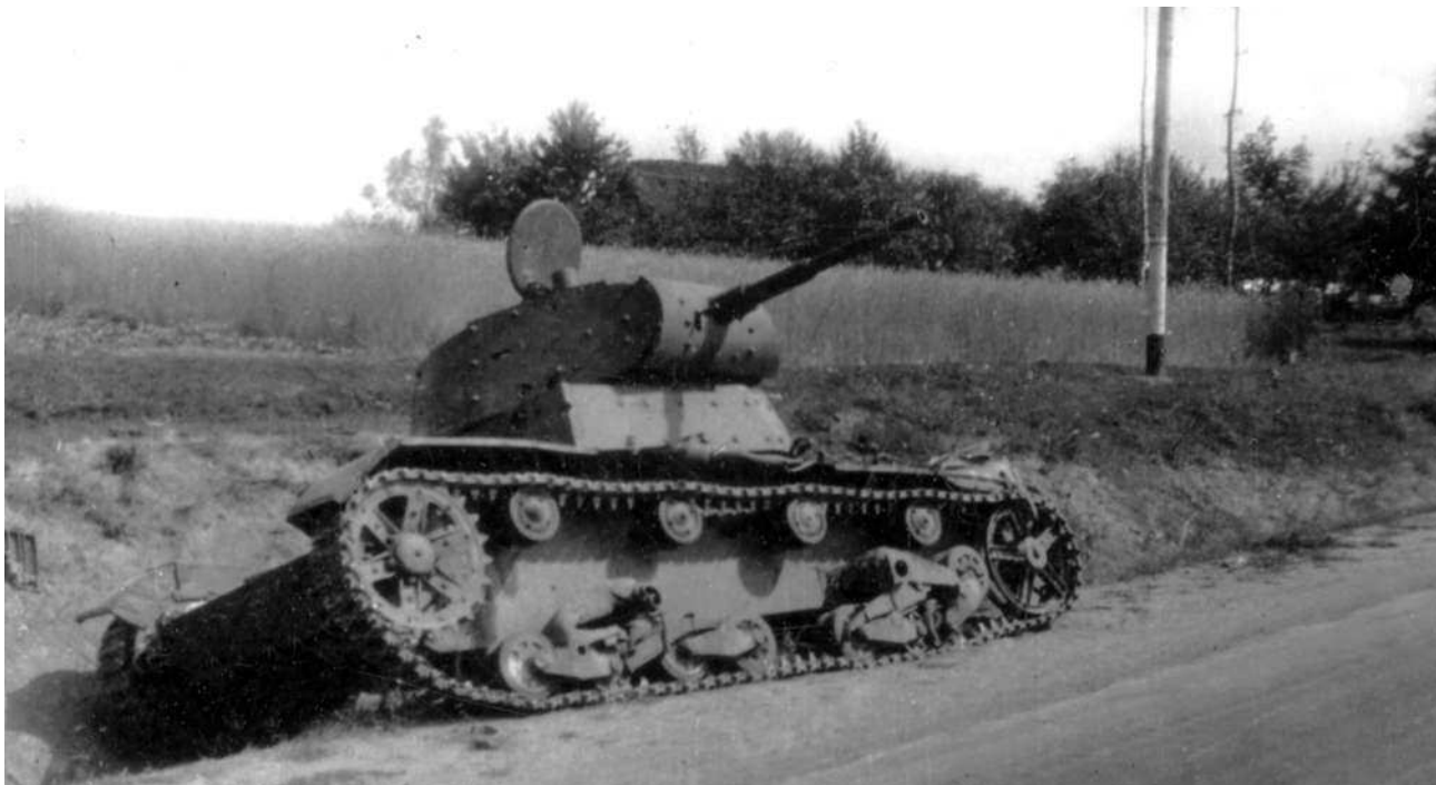
Экранированные танки Т-26: вверху машина с конической башней и наклонными бортами подбашенной коробки, внизу – с цилиндрической башней. Верхний танк заэкранирован в ходе советско-финляндской войны, нижний после нее. Дополнительная броня крепилась к основной при помощи болтов. Обратите внимание на форму бронировки маски пушки на верхнем фото – впоследствии ее использовали при проектировании «объекта 126» (АСКМ).
