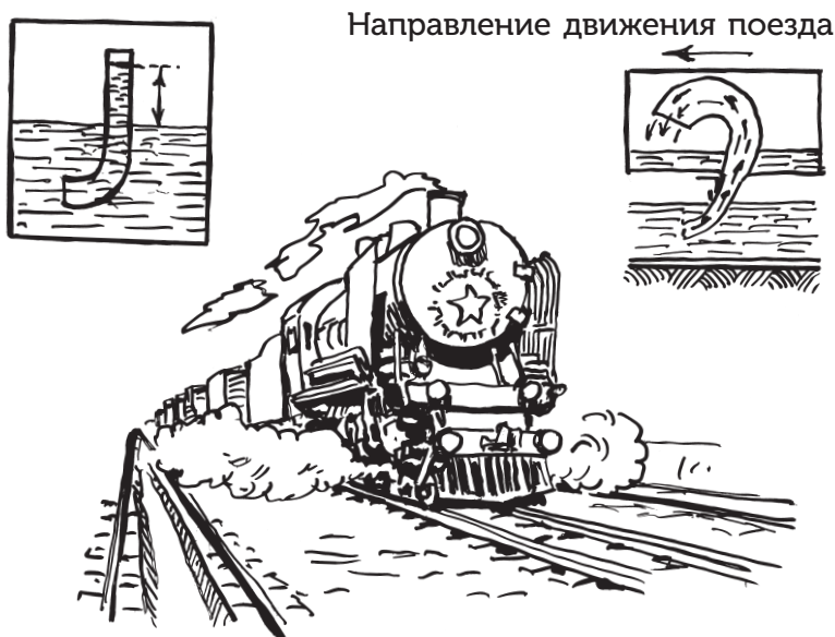
Рис. 4. Как паровозы на полном ходу набирают воду. Между рельсами устроен длинный водоем, в который погружается из тендера труба. Вверху налево — трубка Пито. При погружении ее в текущую воду уровень в трубе поднимается выше, чем в водоеме. Вверху направо — применение трубки Пито для набора воды в тендер движущегося поезда.
