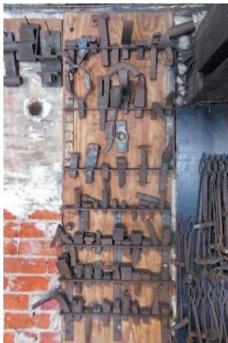
Набор инструментов, используемых с квадратным или круглым отверстиями наковальни.
