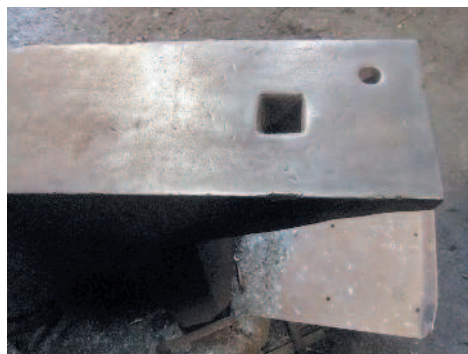
Хвост наковальни лондонского типа с квадратным и круглым отверстиями.
