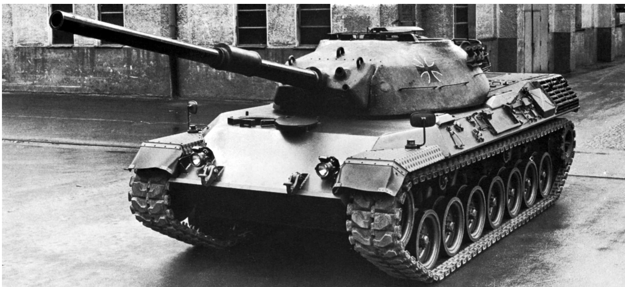
Предсерийный вариант танка Leopard с башней опытного образца рабочей группы А.
