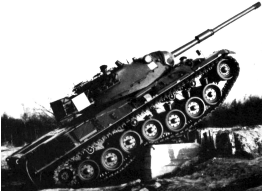
Второй опытный образец танка Leopard рабочей группы А преодолевает стенку высотой 1,15 м.
