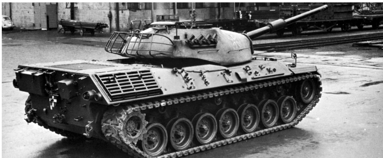
Предсерийный вариант танка Leopard с башней опытного образца рабочей группы А (вид сзади).
