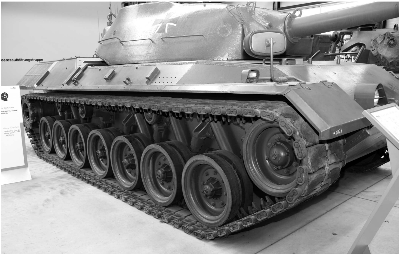
Ходовая часть второго опытного образца танка Leopard рабочей группы А.
