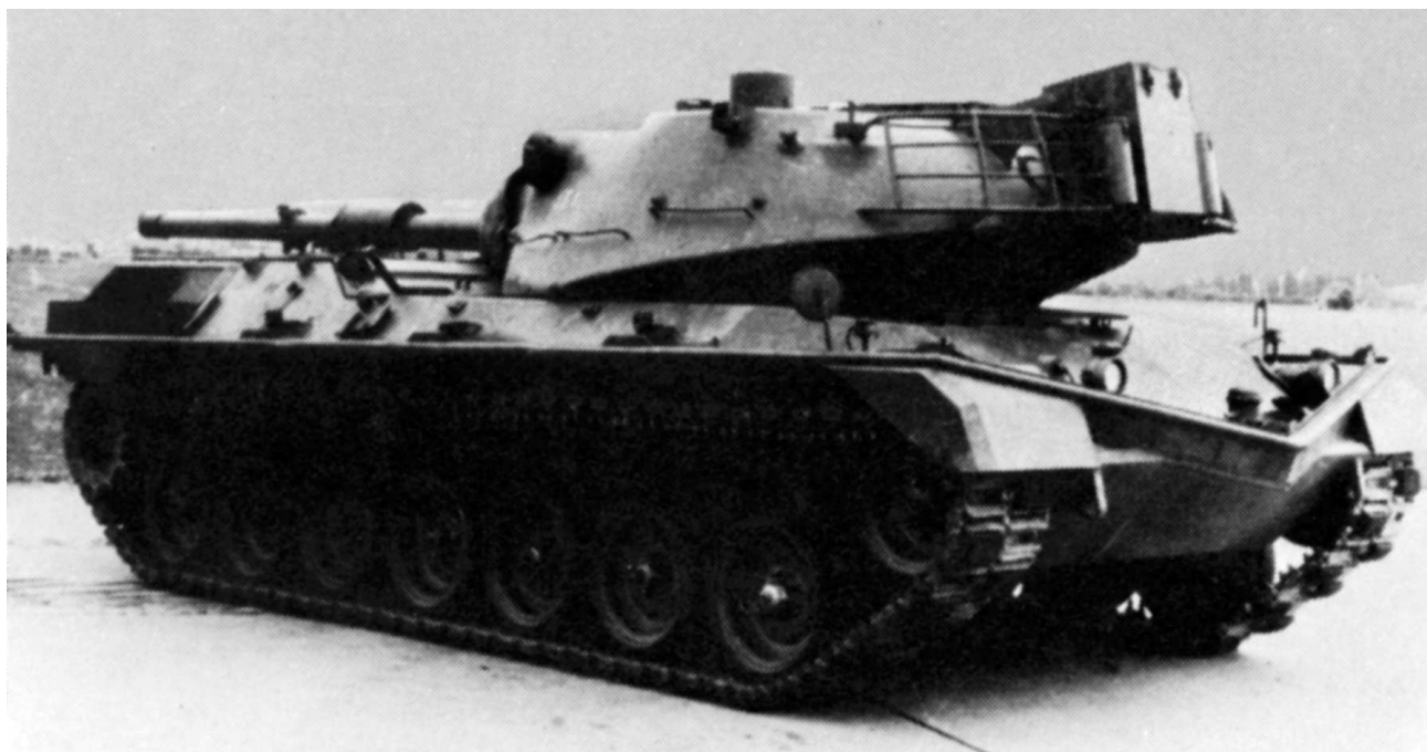
Предсерийный вариант танка Leopard с плавсредствами компании British Pearson Company в походном положении.
