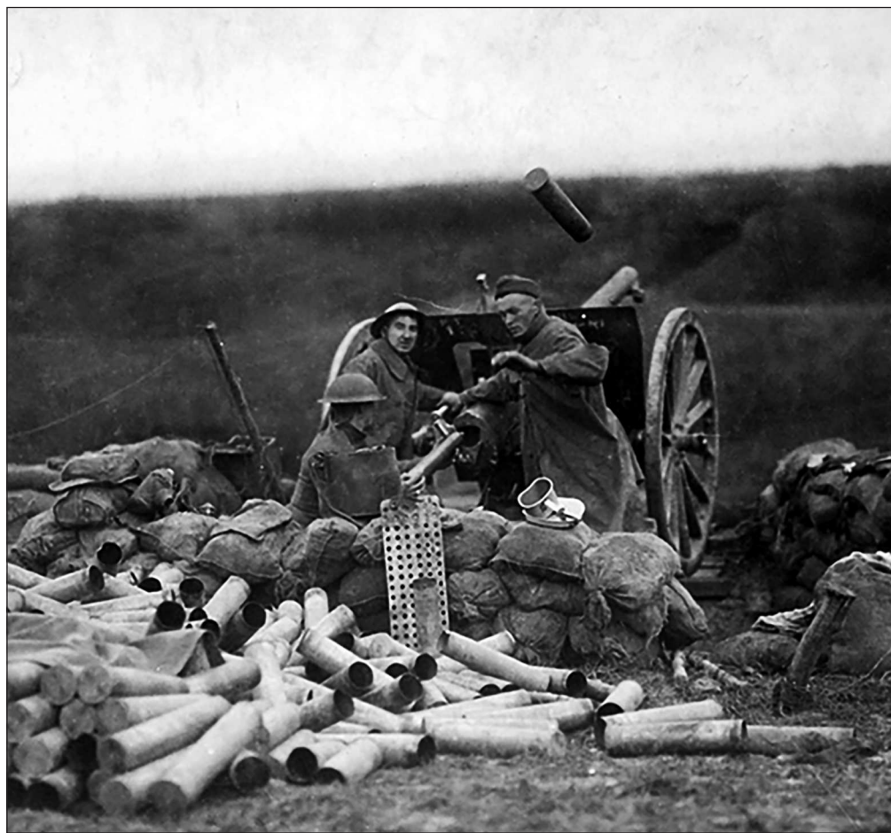
Французская 75-мм полевая пушка образца 1897 г. Тренированный расчет демонстрировал ее феноменальную скорострельность — 30 выстрелов в минуту
