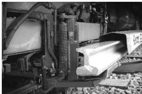
▲ Башмак токоприемника на музейном вагоне Мюнхенского метрополитена
