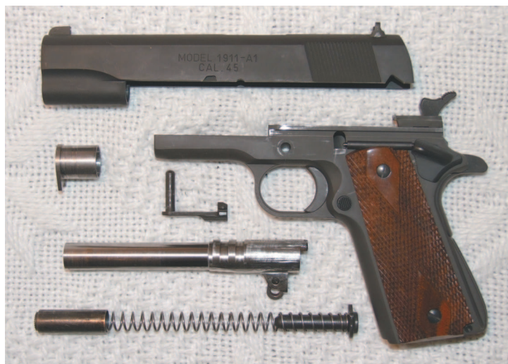
Основные детали (неполная разборка) пистолета M1911.
