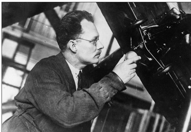
Аэродинамик ЦАГИ А.Н. Журавченко готовит модель самолета И-5 для проведения штопорных экспериментов
