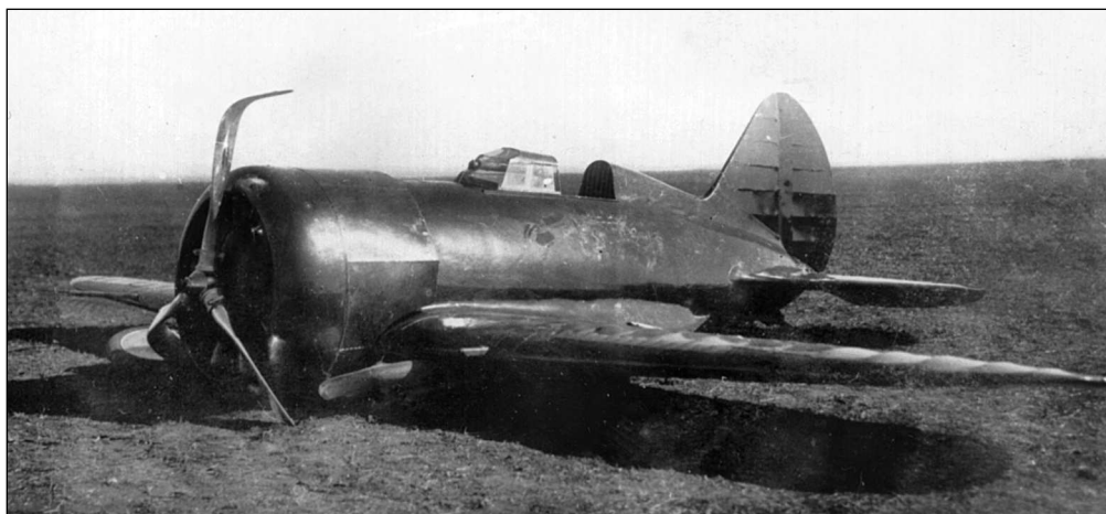
Авария второго опытного ЦКБ-12 бис с двигателем «Райт-Циклон» F-3 по причине поломки шасси 14 апреля 1934 г. При желании на верхнем снимке в районе передней кромки правого крыла можно разглядеть продольные отрывистые линии. Это щели, в которые выдвигались интерцепторы, предназначенные для облегчения выхода из штопора
