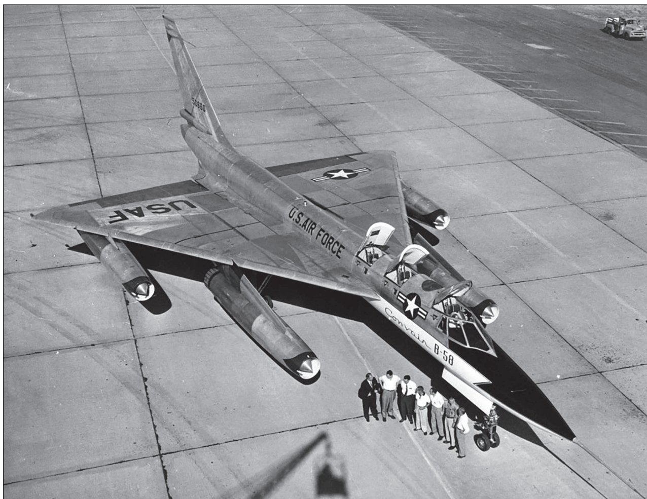
Бомбардировщик В-58 имел сверхзвуковую скорость и треугольное крыло
