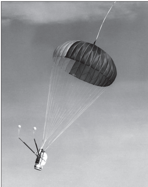
Испытание индивидуальной спасательной капсулы для пилотов ХВ-70
