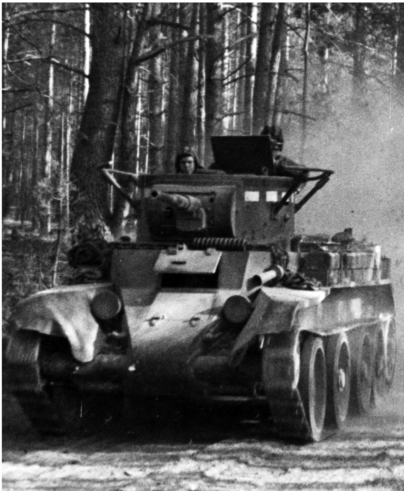
Радийный вариант танка БТ-7 (с цилиндрической башней) на марше в ходе учений. 1936 г. Впереди на крыше корпуса лежит запасная пружина подвески (ЦМВС)
