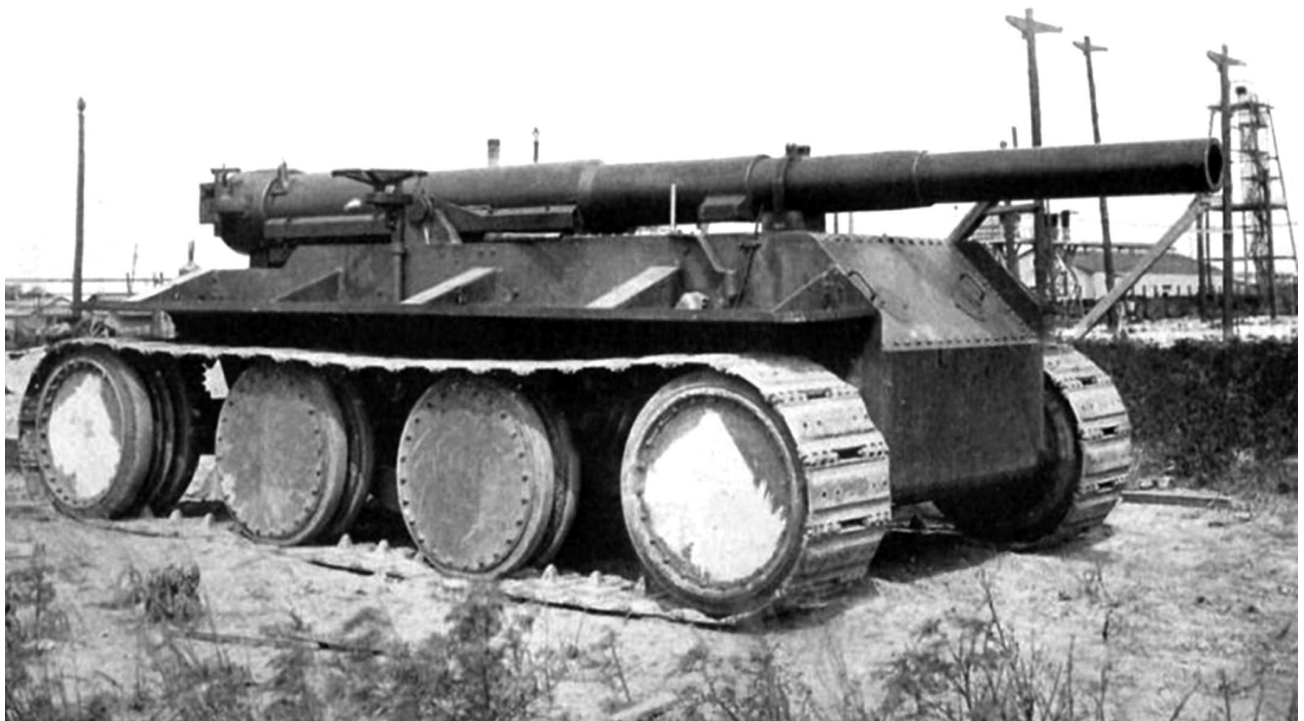
155-мм самоходная установка Кристи М1919 перед испытаниями. 1919 г.
