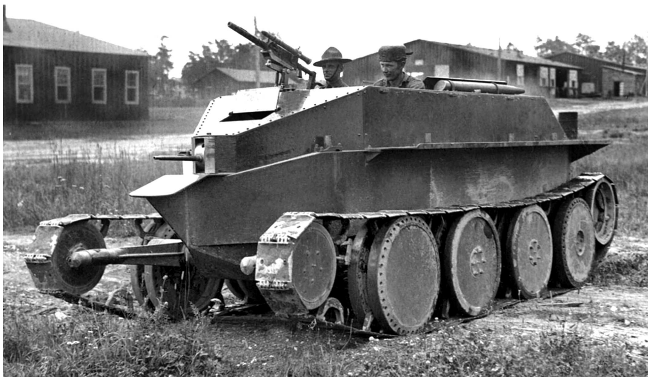
Танк М1928 во время его испытаний американскими военными. Лето 1929 г. Обратите внимание на небольшой лючок механика-водителя — наблюдение за дорогой через него было довольно сложным (ЯМ)
