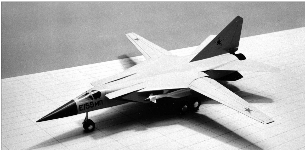
Модель истребителя-перехватчика E-155МП с крылом изменяемой стреловидности и размещением членов экипажа рядом
