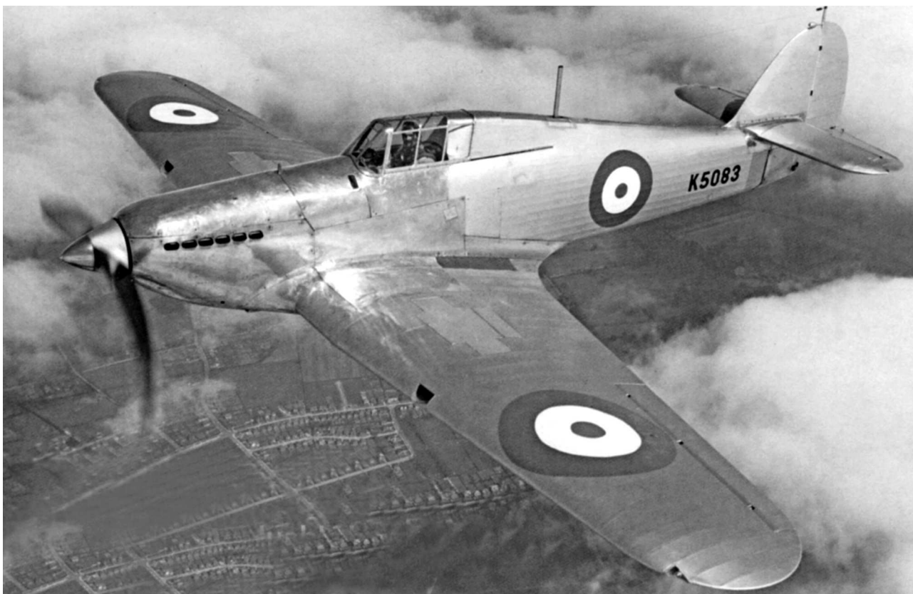
Опытный образец «Харрикейна» в полете. На самолете уже установлена радиостанция, прицел и новый фонарь кабины
