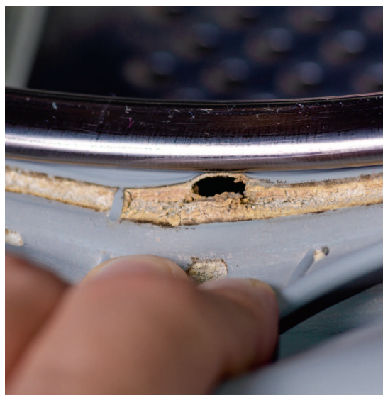
→ «Прохудившийся» уплотнитель стиральной машины
