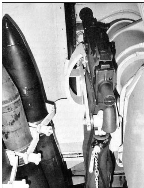
Вид на установку 7,62-мм спаренного пулемета М1919А4. Слева — укладка 90-мм артвыстрелов
