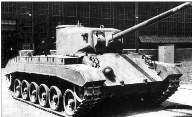
Опытный образец танка T20E3 с торсионной подвеской опорных катков. Июль 1943 года
