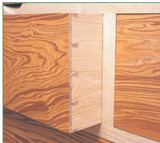
• Оливковый ясень фасадов ящиков контрастирует с боковинами из белого дуба, выделяя полупотайной ласточкин хвост
