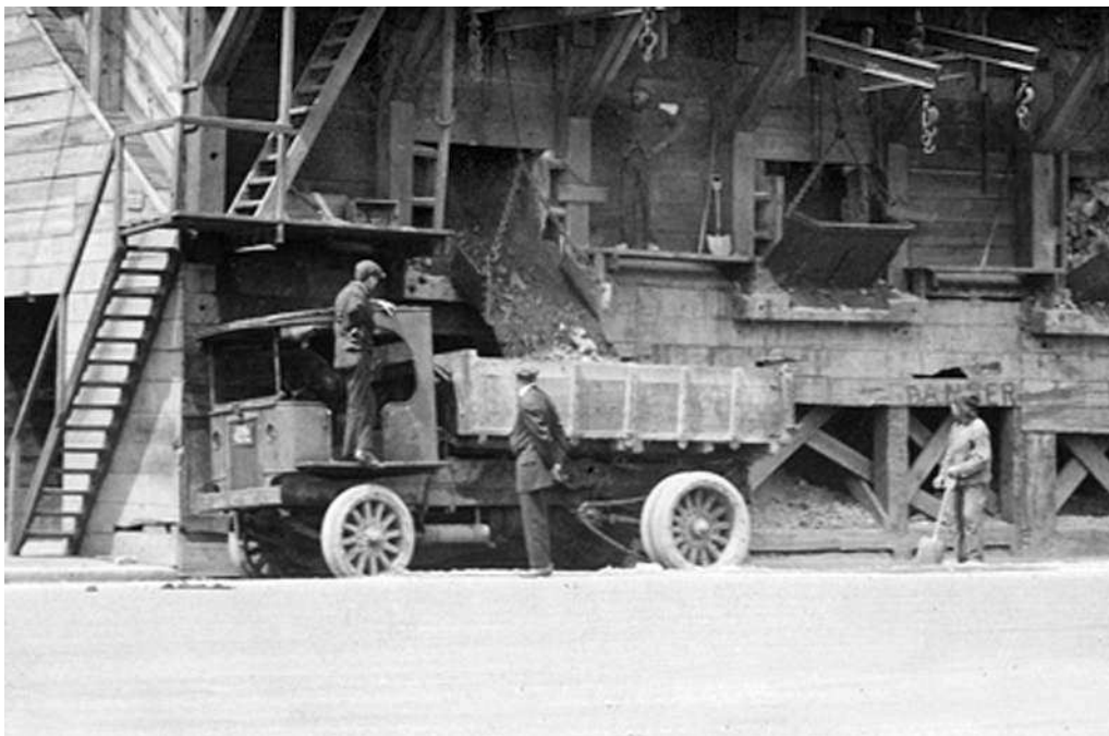
Грузовой автомобиль «Гарфорд» модели D грузоподъемностью в 5 тонн в варианте самосвала. Внешне между собой машины грузоподъемностью в 3 и 5 тонн отличались главным образом шириной колес.
