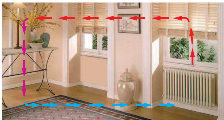
Рис. 10. Нагревание воздуха путём конвекции
