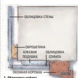
1. Обшивка софита (верхняя оконная кромка) Вырежьте обшивку софита на клеивые подушки и подберите на время схватывания клея.
