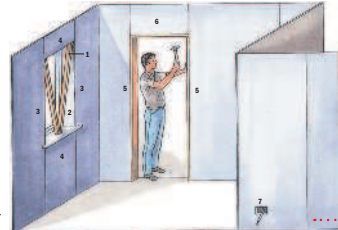
1. Обшивка софита (верхняя оконная кромка) Вырежьте обшивку софита на клеивые подушки и подберите на время схватывания клея.
