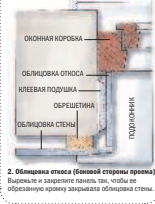
2. Обшивка откоса (внешней стороны проема) Вырежьте и закройте панель так, чтобы ее обрешеточную кромку закрывала обшивочная стена.
