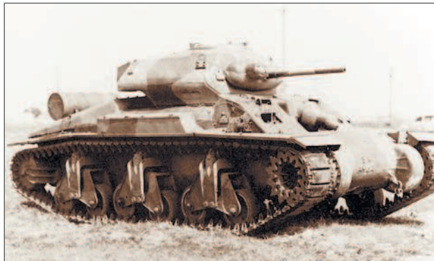
Крейсерский танк Sentinel AC1. На фото хорошо видна характерная форма верхней части корпуса танка с «продавленной» подбашенной коробкой
