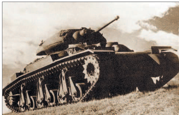
Крейсерский танк Sentinel AC1. Обращает на себя внимание обилие литых деталей в конструкции корпуса и литая башня приплюснутой формы. В конструкции ходовой части явно ощущается французское влияние
