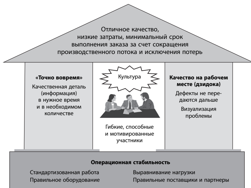
Рис. А.1. Производственная система Toyota (TPS)
