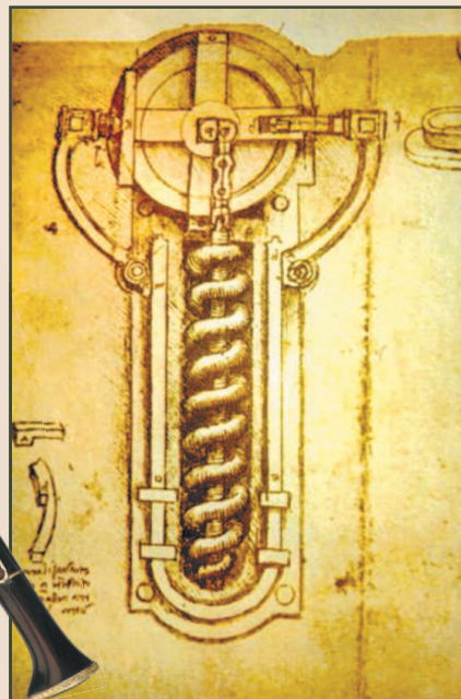
Схема устройства колесцового замка из манускрипта да Винчи «Атлантический кодекс». Пожалуй, это единственное изобретение великого гения в области вооружения, которое получило широкое использование еще при его жизни.
