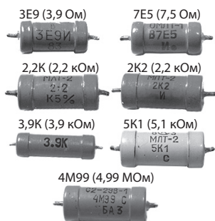
Рис. П1.7. Маркировка номинала сопротивления с дробными числами
