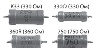
Рис. П1.3. Обозначение номинала сопротивления до 1 кОм
