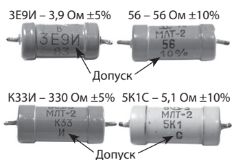
Рис. П1.8. Маркировка допуска на Советских резисторах
