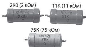
Рис. П1.4. Обозначение номинала резистора до 100 кОм
