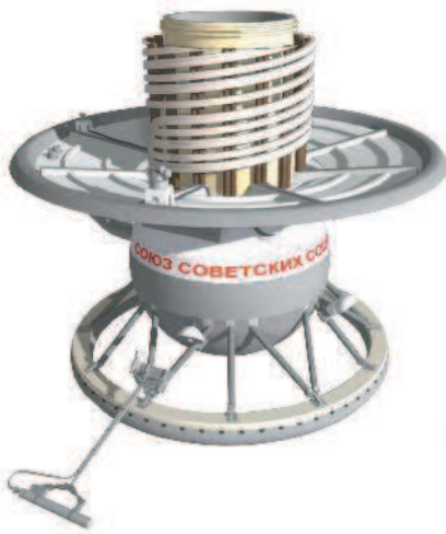
Спускаемый аппарат «Венера-9», СССР
