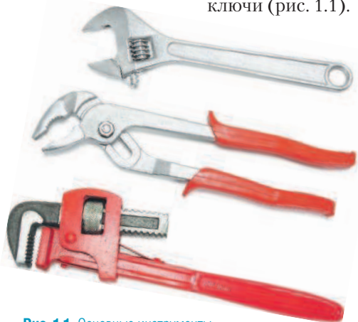
Рис. 1.1. Основные инструменты сантехника — ключи разного типа
