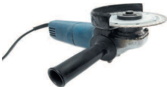
Рис. 1.14. Углошлифовальная машина с защитным кожухом
