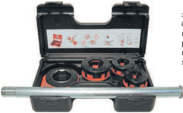
Рис. 1.7. Клупп имеет насадки для труб различного диаметра
