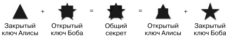
Рис. 1.7. Заключительный этап обмена ключами, на котором обе стороны составляют один и тот же общий секрет. Его нельзя получить, когда видны только открытые ключи
