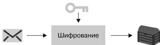
Рис. 1.1. Функция шифрования принимает сообщение и секретный ключ и выдает зашифрованное сообщение — длинную серию цифр, которая выглядит как хаотичный шум
