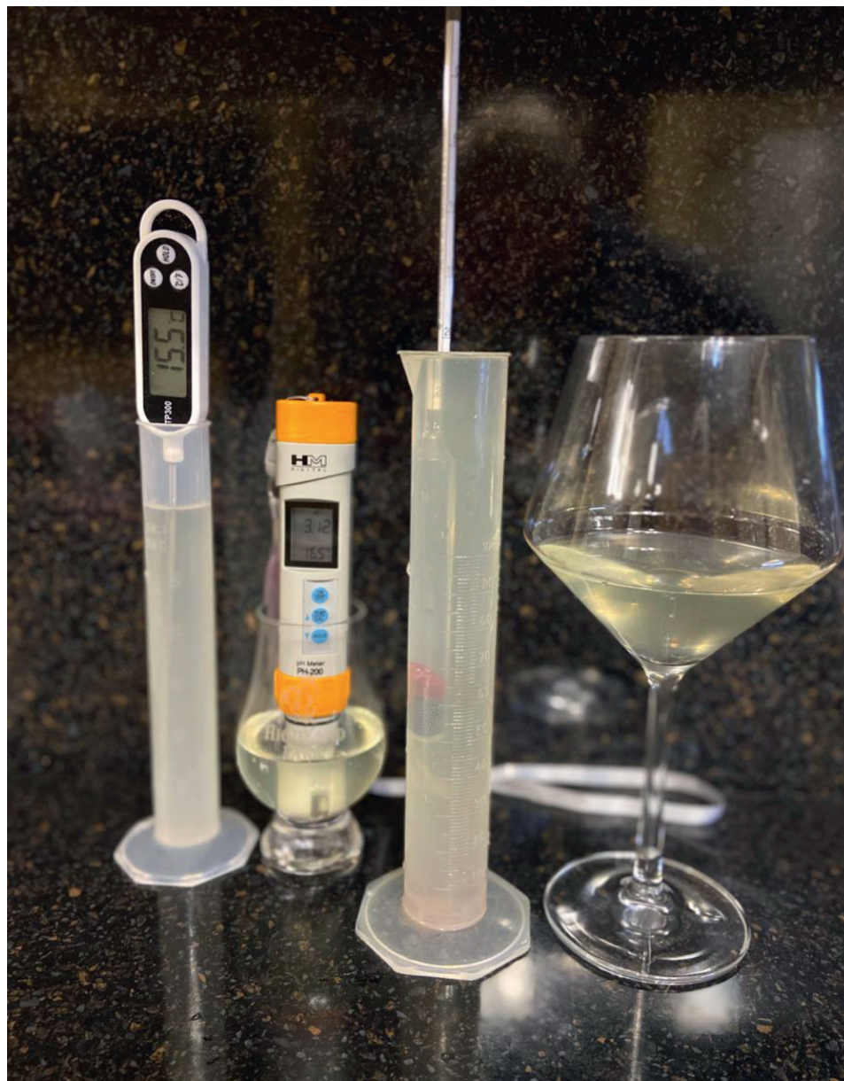
Измерительные приборы слева направо: термометр, pH-метр, ареометр-сахарометр.
