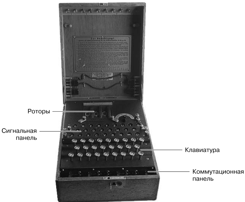
Рис. 1.1. Шифровальная машина «Энигма»
