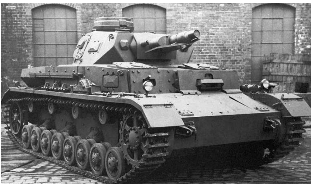
Pz. IV Ausf. E во дворе завода. Обращают на себя внимание 30-мм накладная броня корпуса и отбойник для отгибания антенны под стволом орудия.
