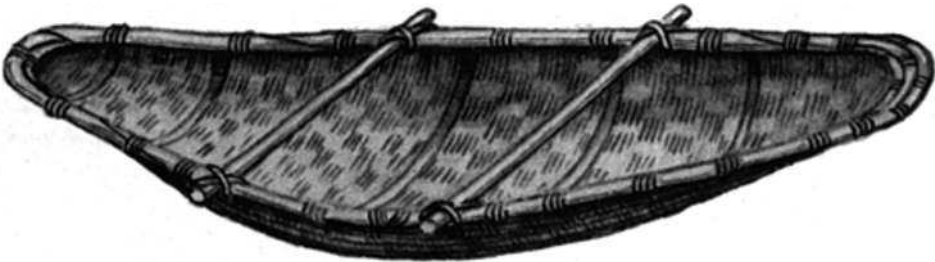
Судно из коры (каркас — из прутьев)
