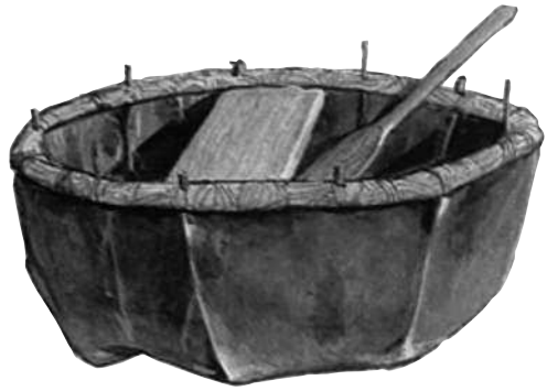
Судно с деревянным каркасом, обтянутым кожами
