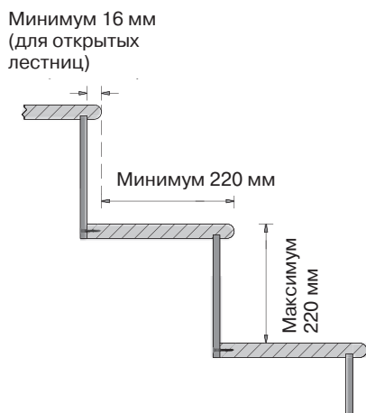
Рис. 1.5 Максимальная высота и глубина ступеней частной лестницы
