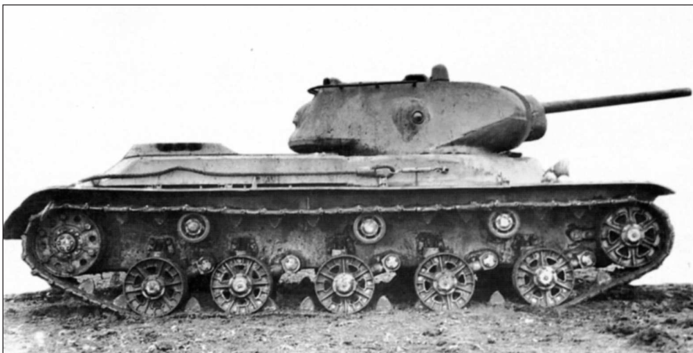
Опытный танк KV-13, вид сбоку. Челябинск, сен- тябрь 1942 года. Машина оснащена ведущими колесами и гусеничными лентами от танка Т-34
