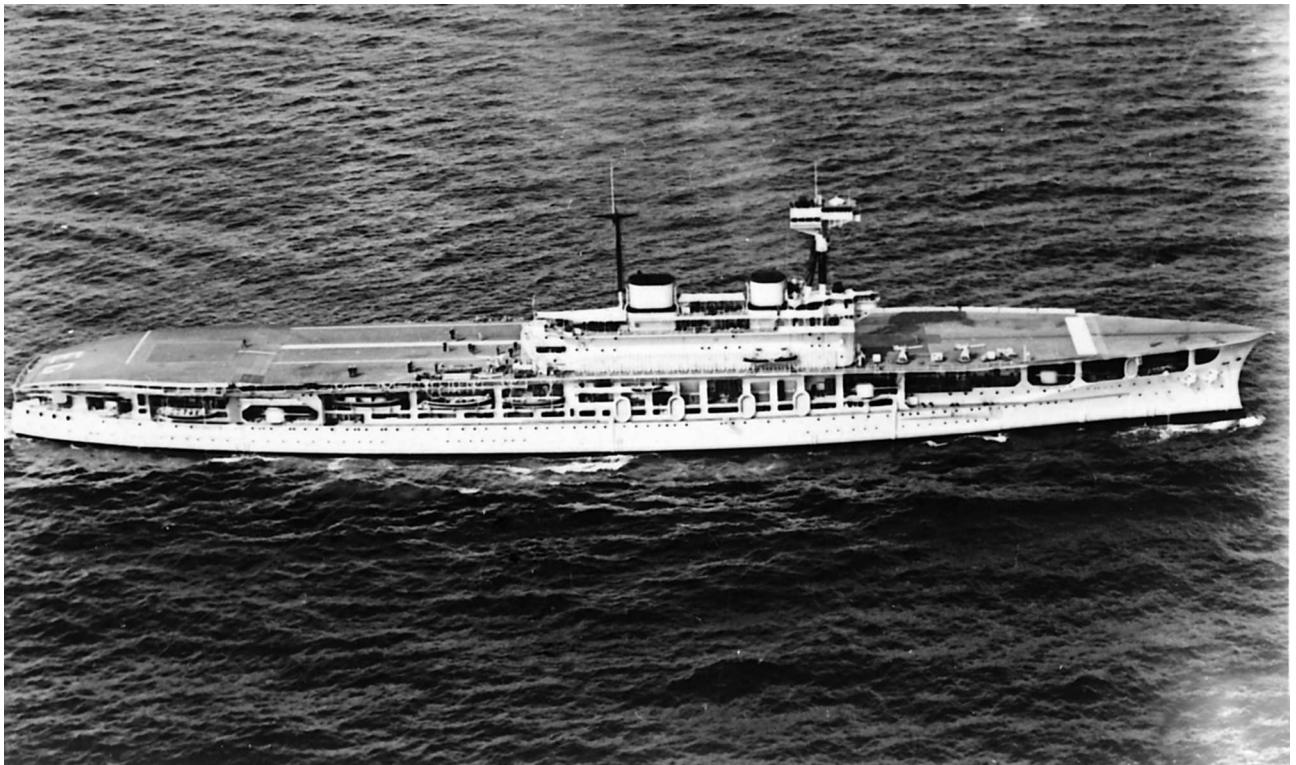
«Игл» в середине 1920-х гг. Корабль несет исходный состав вооружения, включающий пять 102-мм зениток, на грот-мачту добавлена стеньга, на полетной палубе имеется продольный аэрофинишер. Серпообразный форштевень, стойки, поддерживающие полетную палубу, и две дымовые трубы придавали авианосцу неповторимый силуэт
