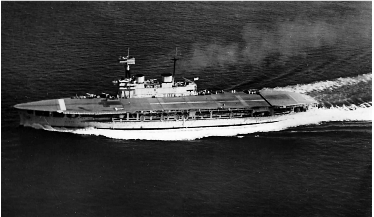
«Игл» в середине 1920-х гг. Корабль несет исходный состав вооружения, включающий пять 102-мм зениток, на грот-мачту добавлена стеньга, на полетной палубе имеется продольный аэрофинишер. Серпообразный форштевень, стойки, поддерживающие полетную палубу, и две дымовые трубы придавали авианосцу неповторимый силуэт
