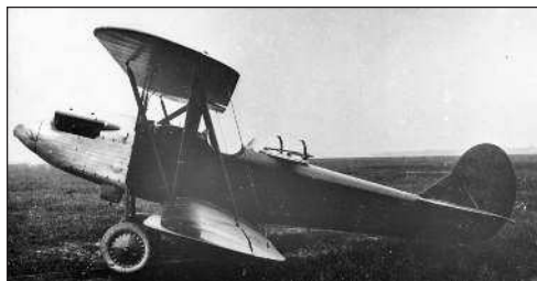
Переходной учебный самолет П-2 с двигателем М-6 300 л.с. в процессе прохождения государственных испытаний в июле 1928 г.
