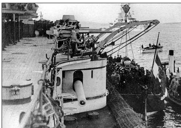
Казематные 150-мм и противоминные 66-мм орудия дредноута «Viribus Unitis»
