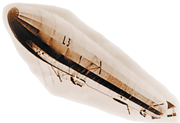
Один из первых германских дирижаблей с вынесенными воздушными винтами
